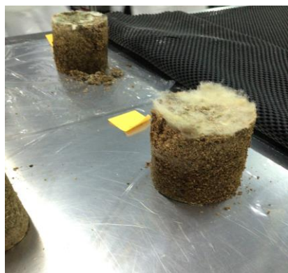
Figura 12: Amostra com micélio apenas na parte superior
